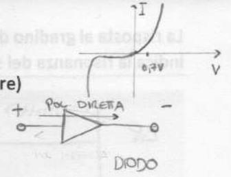
La sorgente muta un passaggio di elettroni di elettroni in fotoni (LED light emitting diode). Non necessariamente è il silicio. Se scorre corrente diodo (POLARIZZAZIONE DIRETTA) allora il diodo può emettere elettroni e viceversa, se arriva un elettrone al fotorilevatore allora passa corrente (EFFETTO FOTO-ELETTRICO) la radiazione luminosa si converte in corrente elettrica.
