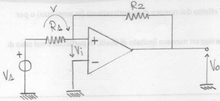
circuito che può trovarsi in due stati di funzionamento e con entrambi gli stati stabili (HO RETROAZIONE POSITIVA)
